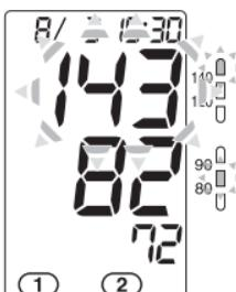
Después de que los valores de medición hayan sido mostrados durante aproximadamente 5 segundos, el manguito de presión se aflojará. (Sin embargo, el tiempo depende del tamaño del brazo.)
