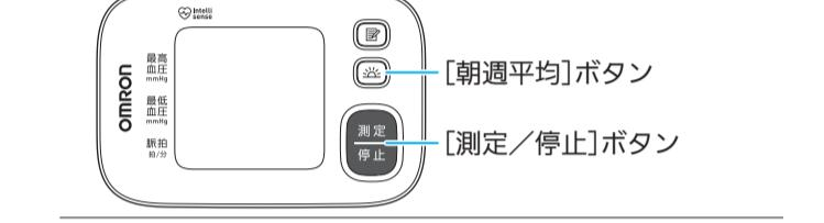
① 電源の切れた状態で、[朝週平均] ボタンを押しながら、[測定/停止] ボタンを 5 秒以上押し続ける
