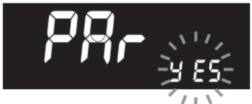
Si desea entrar en el modo de emparejamiento, pulse el botón Main una vez y la pantalla indicará “yes”. A continuación, oprima SET para confirmar y el medidor mostrará “CLr”. El medidor se apagará automáticamente y el Bluetooth indicador comenzará a parpadear, lo que significa que el medidor está en el proceso de emparejamiento con un receptor Bluetooth.
