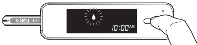
1. Comienza con el medidor apagado. Inserte una tira reactiva para encender el medidor. En la pantalla aparecerá “”.
