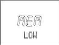
The image shows the text 'MEM' in a large, stylized font above the text 'LOW' in a smaller font.                                                                   | Bei Wechsel in das Menü <b>Training</b> meldet die Pulsuhr <b>MEM LOW</b> , wenn weniger als 10% des Speichers oder weniger als 10 Runden frei sind.                                            |
