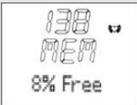
The image shows the text '138' in a large font, 'MEM' in a smaller font, and '8% Free' in a smaller font below. There is a small arrow icon to the right of 'MEM'. | Während des Trainings meldet die Pulsuhr alle 5 Sekunden <b>MEM x% Free</b> , wenn weniger als 10% des Speichers frei sind.<br>Auf dem Bild: <b>MEM 8% Free</b> (noch 8% frei).                 |
