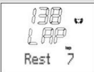
The image shows the text '138' in a large font, 'LAP' in a smaller font, and 'Rest 7' in a smaller font below. There is a small arrow icon to the right of 'LAP'.  | Während des Trainings meldet die Pulsuhr alle 5 Sekunden <b>LAP Rest x</b> , wenn weniger als 10 (von insgesamt 100) Runden frei sind.<br>Auf dem Bild: <b>LAP Rest 7</b> (noch 7 Runden frei). |
