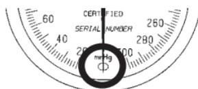
**Nota:** calibre tienda con la válvula en la posición de escape completo.
